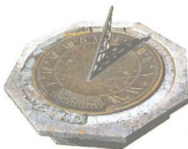
Гномон отбрасывает тень на циферблат солнечных часов
