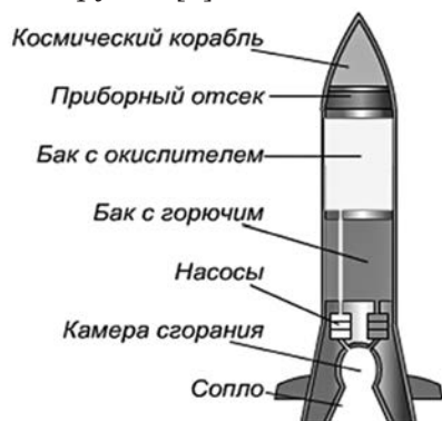
Рис. 1. Устройство одноступенчатой ракеты [4]
