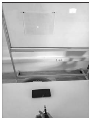
Рис. 2. Фотография опыта по наблюдению дифракции лазерного излучения на дисплее смартфона
