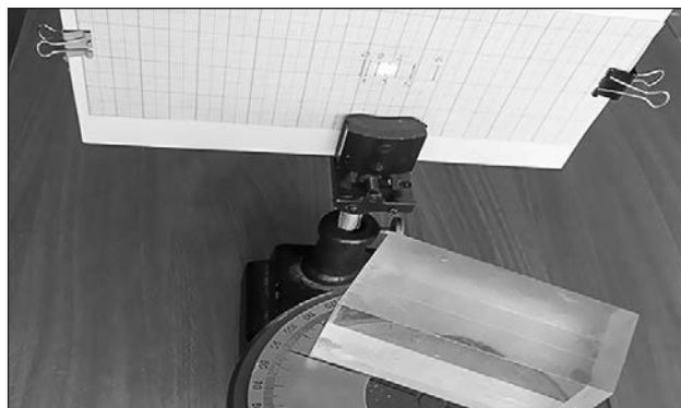
Рис. 8а. Прохождение луча лазера через плексигласовый брусок
