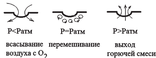
Рис. 3. Три фазы смешения воздуха и газа в каждом отверстии трубы Рубенса
