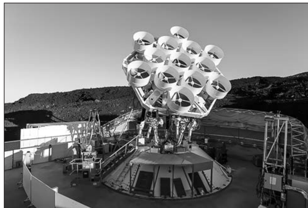
Рис. 5. Радиотелескоп AMiBA с тринадцатью 1,2-метровыми антеннами (изображение с сайта http://ytla.asiaa.sinica.edu.tw )
