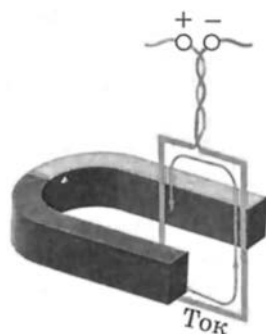
Рис. 2. Действие магнитного поля на рамку с током
