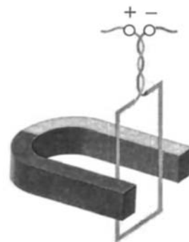
Рис. 1. Действие магнитного поля на рамку без тока
