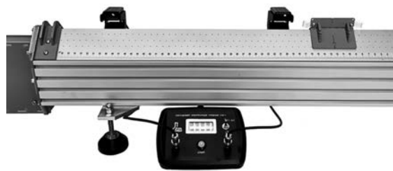
Рис. 7. Общий вид установки для изучения движения по наклонной плоскости
