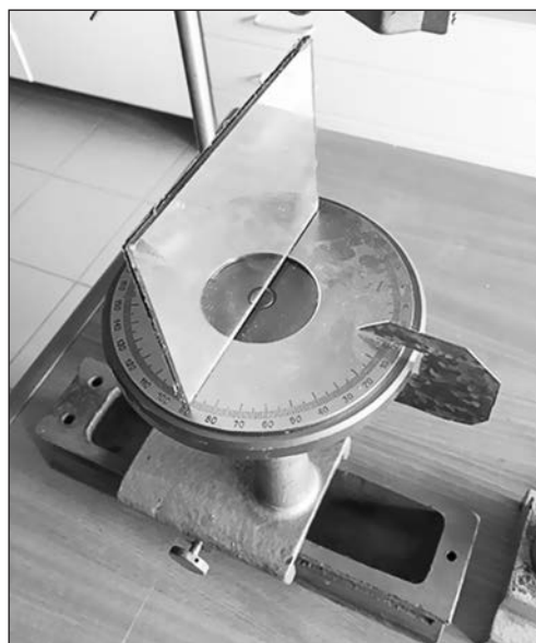
Рис. 7. Плоское зеркало на поворотном столике с угловой шкалой и указателем
