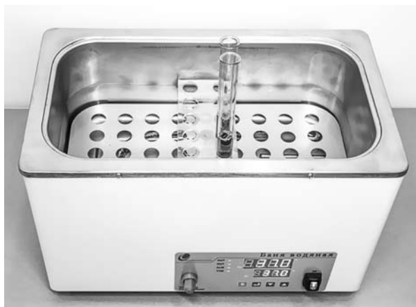
Рис. 15. Размещение пробирок в рабочей камере водяной бани
