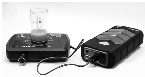
Рис. 14. Магнитная мешалка работает от аккумуляторного источника питания
